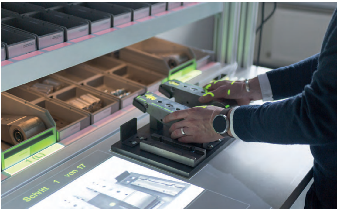
Projektionsgestütztes Assistenzsystem im Labor für Industrial Engineering der Hochschule OWL
